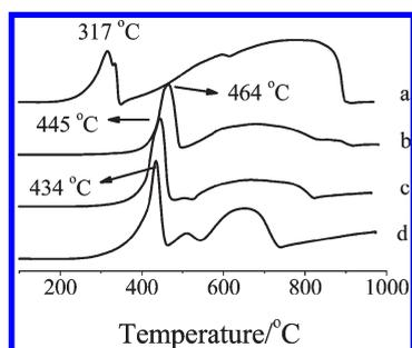
**Figure 4.**  $\text{H}_2$ -TPR profiles of synthesized  $(\text{Fe}_{3-x}\text{Ti}_x)_{1-\delta}\text{O}_4$ : (a)  $x = 0$ ; (b)  $x = 0.3$ ; (c)  $x = 0.7$ ; (d)  $x = 1$ .
